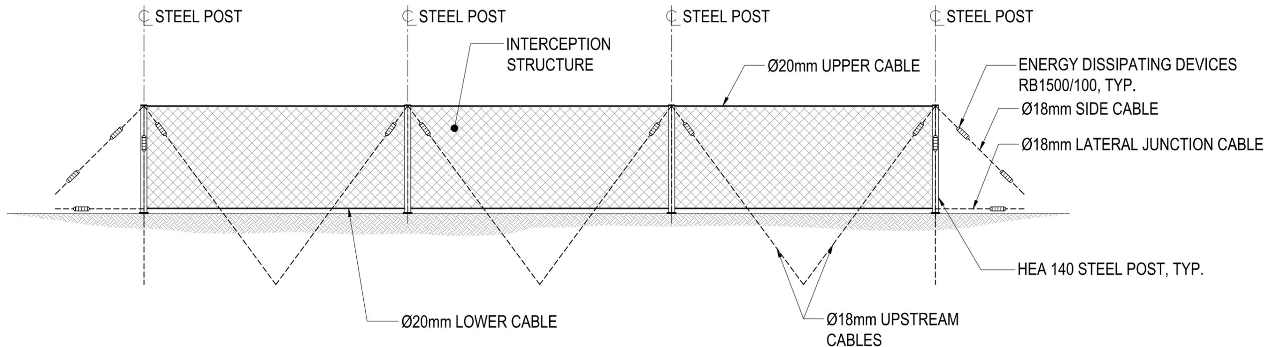
1 ROCKFALL FENCE TYPICAL ELEVATION
